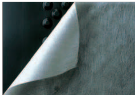
Fondaline Drain má v sobě silnou geotextilní membránu, která vytváří odvodňovací kanál mezi zásypem a hydroizolací.
